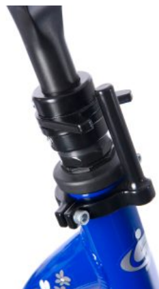
Limitador de dirección triciclo Momo
